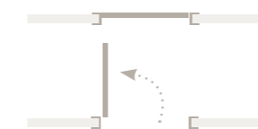
** realizzabile solo con l'utilizzo di cerniere a scomparsa | only possible using flush hinges | réalisable uniquement avec des charnières escamotables | realizable exclusivamente con bisagras integradas | nur mithilfe des Einsatzes von versenkten Scharnieren realisierbar | выполняется только с использованием скрытых петель
