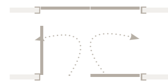
* anta semifissa apribile all'occorrenza | semi-fixed leaf that can be opened at need | porte semi-fixe ouvrante si nécessaire | hoja semifija practicable cuando es necesario | halb feststehender Türflügel, zum Öffnen bei Bedarf | п сивн я створк открыв ется по необходимости
